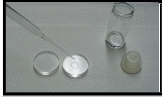
شكل (10 - 11) يبين الشكل النموذج السائل ووضعة على خلية بروميد البوتاسيوم
