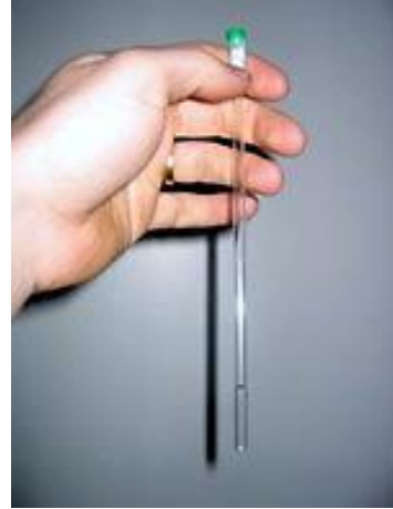
شكل (15-8) أنبوبة العينة السائلة لجهاز الـ NMR
