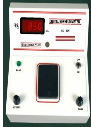
شكل (10-4) جهاز قياس الضبابية ومخطط مسار الشعاع
