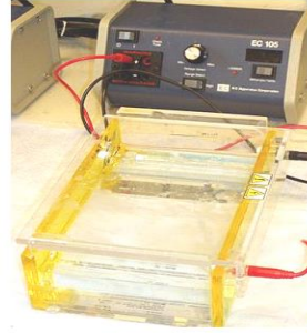
شكل (2-23) خلية الترحيل الكهربائي ذو الشريحة الجيلاتينية (Gel electrophoresis cell)
